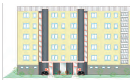
Montage von 2 außen liegenden Aufzügen, Ansicht Miteingangs
